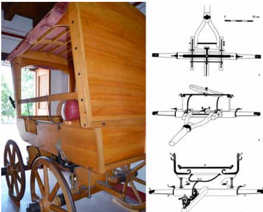
FIGURA 2.— Carruca de Kozàrmislény , de la antigua Pannonia , reconstruida en el museo de Augusta Raurica (Suiza). Dibujos del tren delantero, según Zsolt Mráv, y trasero, según Kiss (cortesía del autor).
