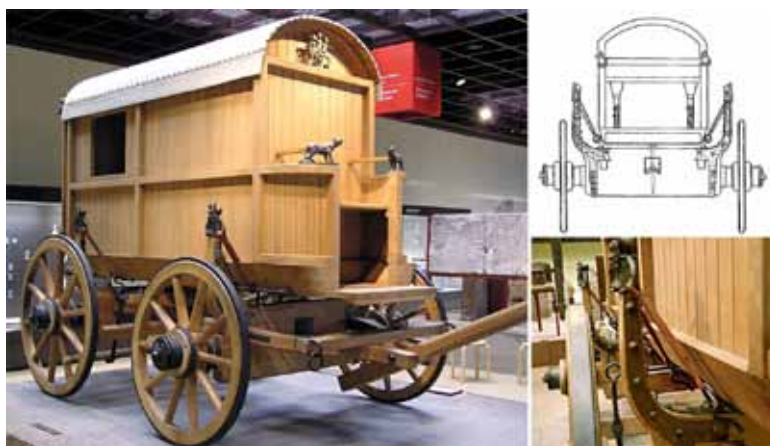
FIGURA 3.— Carruca dormitoria de Wardartal (Bulgaria), reconstruida en el museo de Colonia. Detalles de la suspensión mediante correas de cuero (cortesía del autor).
